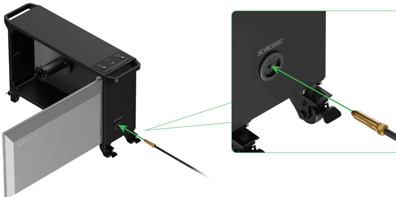
(3) 插入送丝电机，直至送丝管铜嘴的凸起恰好抵住送丝电机的侧板。
