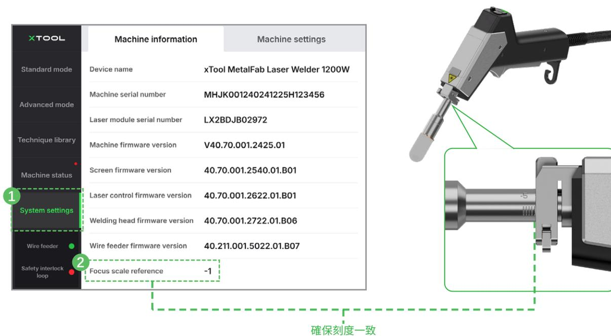
(2) 打开卡扣, 推拉刻度管调节刻度, 使其与触控屏上显示的参考刻度一致。
