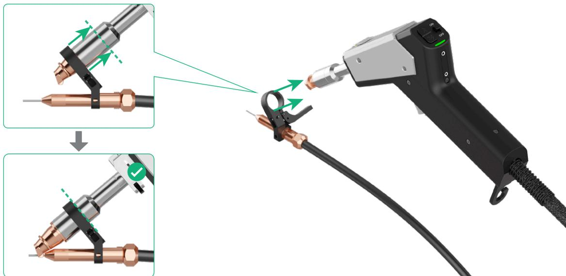
(4) 确保送丝嘴位置居中，且焊丝从焊枪喷嘴末端的凹槽中间伸出，然后锁上卡扣。
