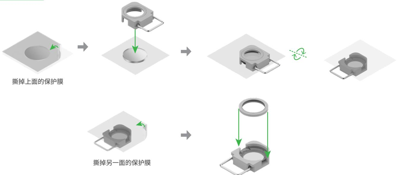
完成镜片更换后, 将保护镜装回焊枪。
