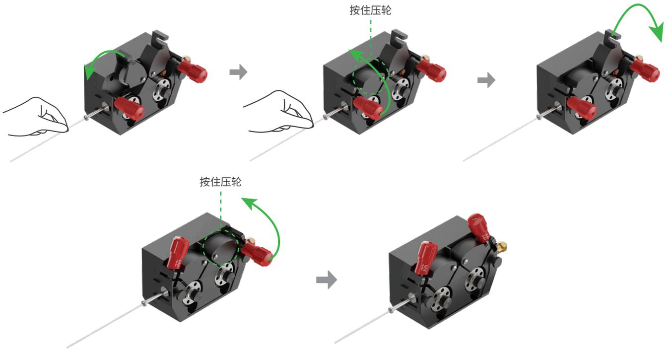
(3) 旋转送丝电机左右杆旋钮，调节送丝压力。旋钮底部所达到的刻度越大，表示压力越大。
